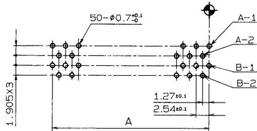
基板穴明寸法 (コネクタ搭載側より見た図)
