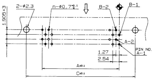
基板穴明け寸法 (コネクタ搭載側より見た図)
